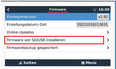
Nach erfolgreicher Deaktivierung der automatischen Software Aktualisierung installieren Sie die auf dem Speicherstick enthaltene Software auf den Cerbo-GX. Anschluss des Speicherstick an dem USB-Port (siehe Abbildung)
