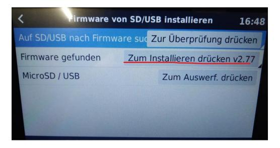
Die Software wird installiert und das Gerät schaltet ab und startet erneut.
