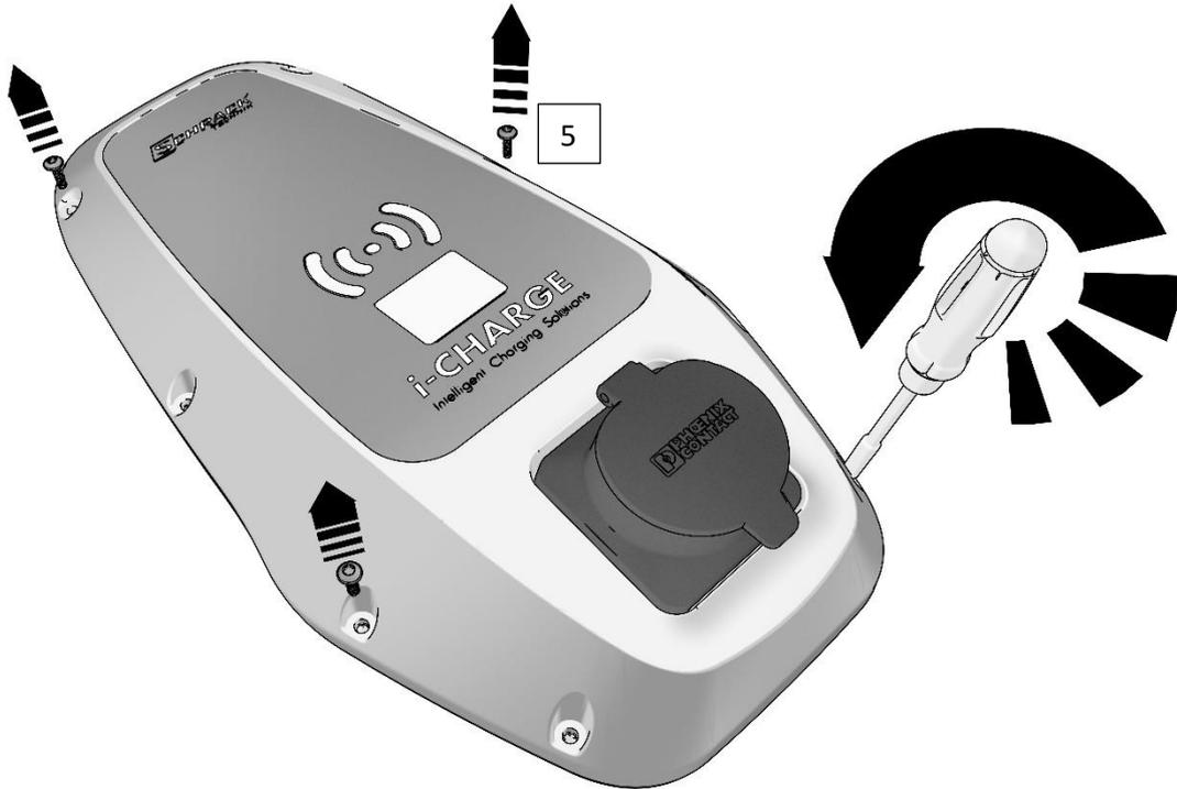
Bild 5 Öffnen des Deckels
